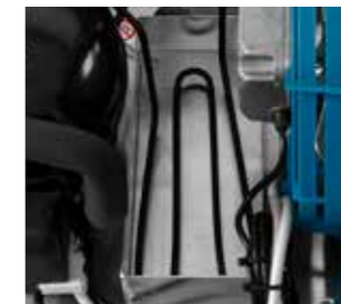
Verdampfung ohne Kosten Das beim Enteisen entstehende Wasser verdampft durch die ausströmende Wärme des Kühlsystems.
